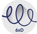
Minimum Bükülme Yarıçapı Minimum Bending Radius
